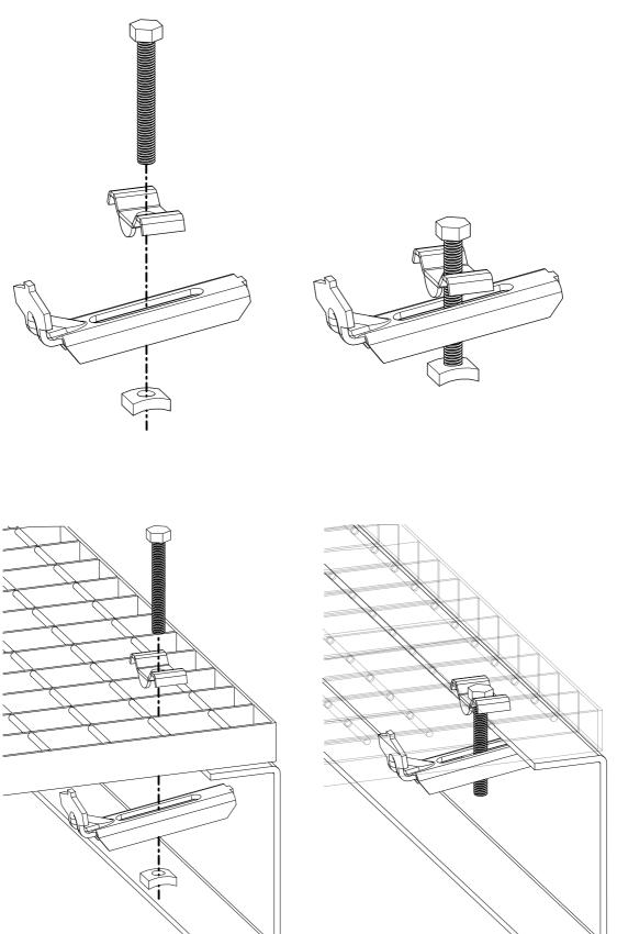
Montageanleitung: Befestigung eines Gitterostes mit einer Befestigungsklammer komplett, an einem U-Träger.
