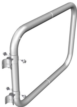
Beachte, je nach Handlaufbügeltyp wird die Tür horizontal oder vertikal montiert. Befestige die Scharniere mit 4xM5x22 mm selbstschneidenden Schrauben in die dafür vorgesehenen Löcher.
