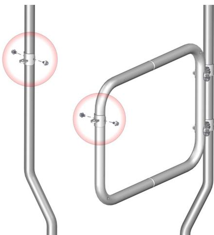
Wenn die Tür mit einem Schloss ausgestattet werden soll, können am Tür- u. Handlaufbügel 2 Halbschalen mit Ösen montiert werden. (4xM5x22 mm)
