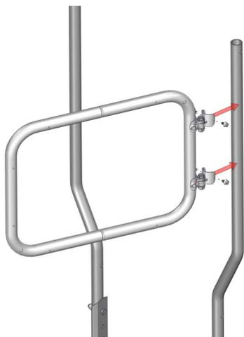
Montiere die Tür am Handlaufbügel mit 4xM5x22 mm, selbstbohrenden Schrauben in der passenden Höhe. Im geschlossenen Zustand liegt der Türbügel am gegenüberliegenden Handlaufbügel an.
