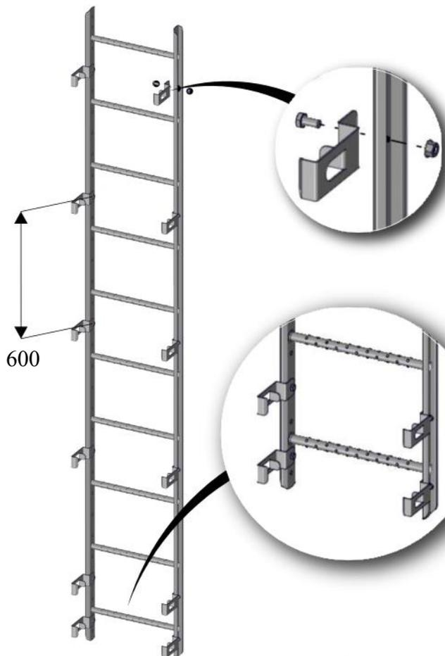
Die Führungswinkel werden gemäß der Abbildung an der festen Leiter montiert. Am unteren Ende der festen Leiter werden 2 zusätzliche Führungen angebracht. Verwende dazu mitgelieferte M10x20 mm Schrauben und Muttern.
