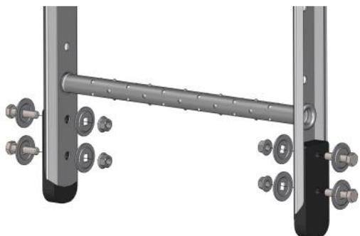
Befestige die Gummipuffer mit je 2x M10x40 + gr. Scheiben u. Muttern am Ende der Falleiter. Besteht eine Falleiter aus mehreren Elementen, so ist darauf zu achten, dass diese unbedingt gerade montiert werden, damit die Leiter nicht verkantet.
