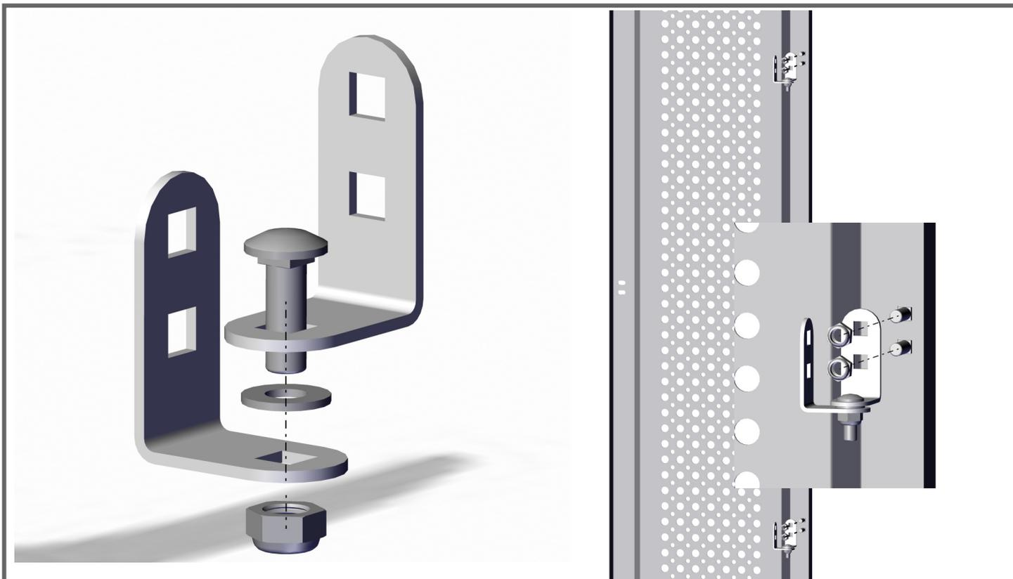
Beginne mit dem Zusammenbau der Winkel für die Scharniere. Dann werden die Scharniere an der Türplatte befestigt.
