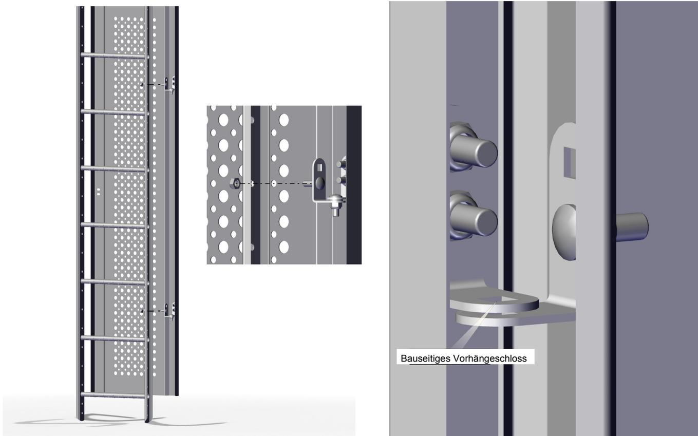
Die Klettersperre wird an der Leiter montiert. Befestige zum schluss je einen Winkel an der Klettersperre und an der Leiter für ein bauseitiges Vorhängeschloss. Der komplette Satz "Klettersperre" besteht aus: 1x Türplatte; 6x Montagewinkel; 11x M10x30 mm Schlossschrauben; 2x M10 Scheiben; 11x M 10 Muttern.
